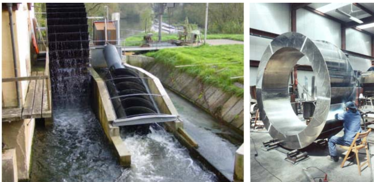
Rys.18 Ślimak hydroenergetyczny firmy Ritz-Atro[8] przy młynie Diebacher Rödermühle na Soławie Frankońskiej oraz współczesne koło wodne na hali montażowej firmy BEGA [9]
